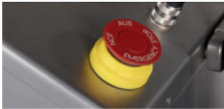
Ein zentral positionierter Notausschalter in Signalfarbe garantiert eine Abschaltung aller Funktionen in Sekundenbruchteilen.
