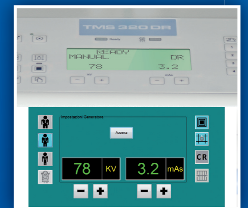
Impostazione dati radiologici sia da pannello di comando che da PC Radiological data setting from both control panel and PC interface
